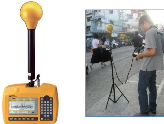
รูปที่ 3 - เครื่องมือตรวจวัดความเข้มสนามแม่เหล็กไฟฟ้า SRM
